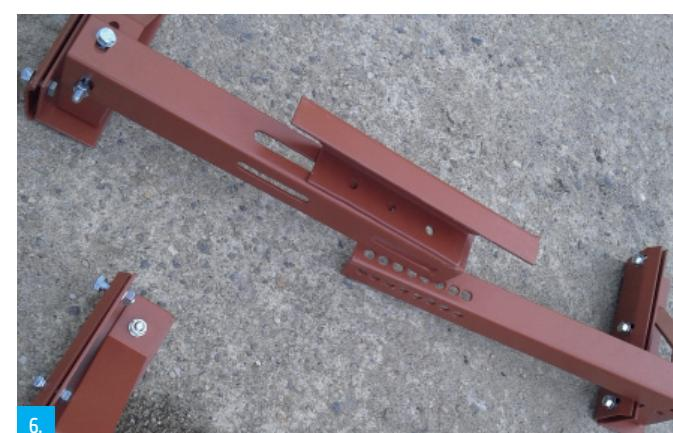
Připravená hrazená s držáky k montáži na krytinu s ještě nesešroubovanou střední částí, tu sestavíme až po přiložení na krytinu dle rozteče falců. Další hrazená si již můžeme podle první smontované a vyzkoušené zkompletovat již na zemi či lešení.
