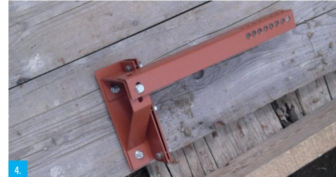
Částečně zkompletovaná levá část hrazdy s držáky.
